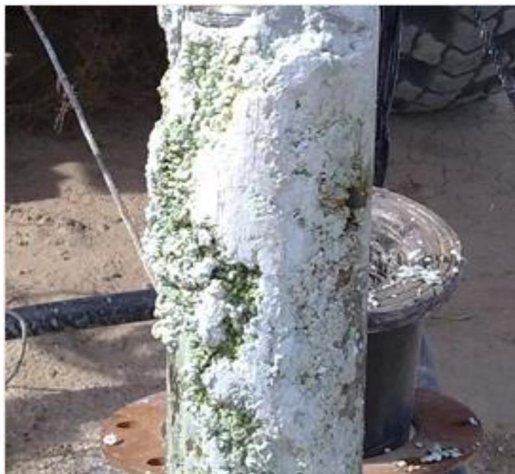
Рисунок 1.2 – Погружной насосный агрегат поднятый со скважины с наростами химических осадкообразований
