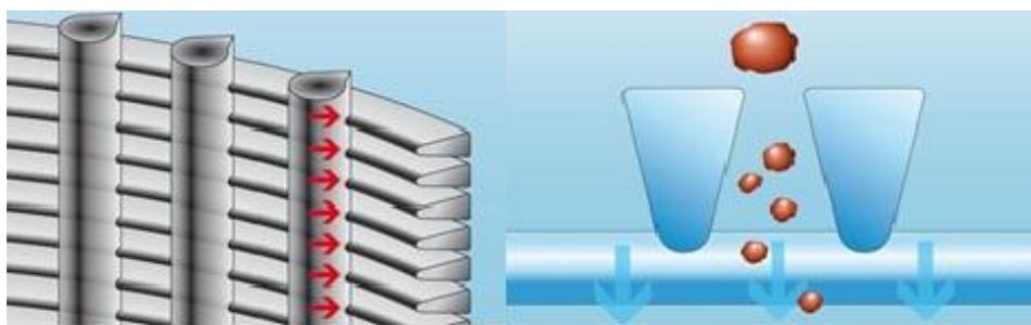
в. вид изнутри, навивка проволоки на стержневой каркас
